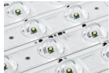
Figuur 7: Voorbeeld 2 PCB met leds en lenzen
