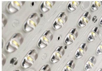
Figuur 6: Voorbeeld 1 PCB met leds en lenzen
